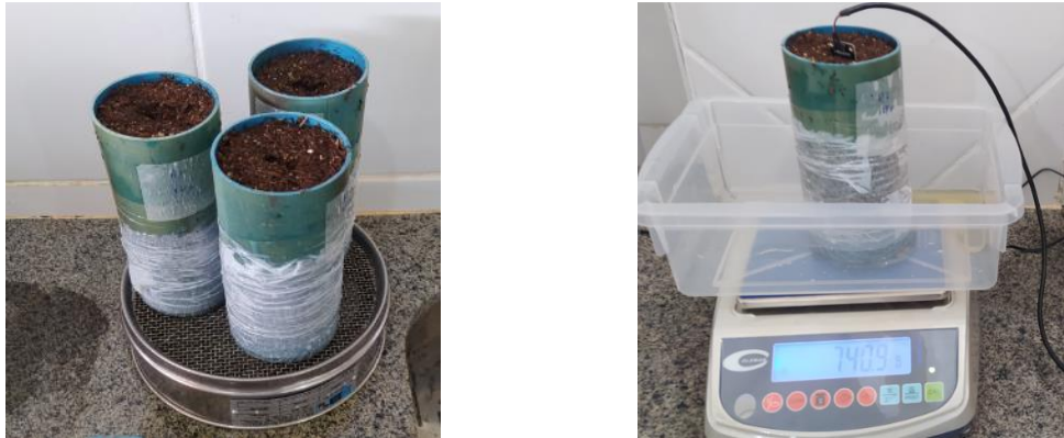
Figura 3 – Drenagem das amostras (A); pesagem das amostras e coleta de sinal de sonda (B).
